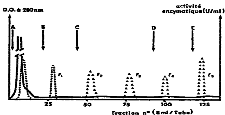
Fig. 1. Chromatographie d'une préparation cellulasique de Trichoderma viride sur cellulose réticulée. Colonne de 28 × 2 cm. Elution par Tampon d'équilibre (A) et par solution tamponnée de carboxyméthylcellulose à: 0.5 g·l -1 (B); 1.75 g·l -1 (C); 2 g·l -1 (D) et 3 g·l -1 (E). D.O. à 280 nm, ● = pouvoir réducteur apparu après incubation sur carboxyméthylcellulose; ▲ = pouvoir réducteur apparu après incubation sur cellulose.
